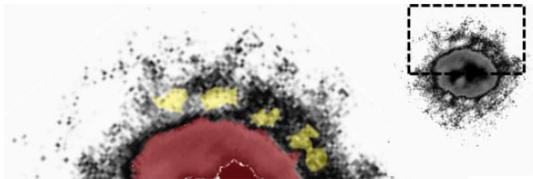
Fig. 3 – Imagem ampliada de uma típica imagem de absorção contendo vórtices gerados na interface entre as frações condensada e térmica da nuvem.
